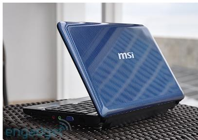
**MSI Wind U135** dispone di una tastiera ad isola, al contrario di una versione classica adottata da **MSI Wind U130**, mentre il touchpad del Wind U135 è più largo. Secondo le prime informazioni diffuse da MSI, l'autonomia dei due netbook dovrebbe aggirarsi intorno alle **7.5 ore con batteria a 6 celle**,
