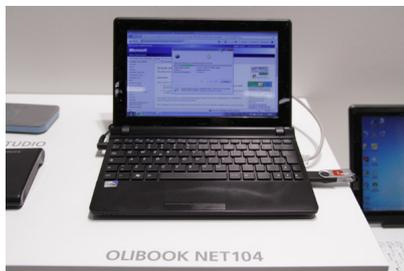
Le differenze invece sono nell'autonomia e nella batteria. **Olibook Net104** possiede una batteria a **6 celle**, che garantisce 9 ore di lavoro consecutive, mentre Olibook M1030 integra una batteria da 2200mAh. Questa caratteristica influisce anche sul peso, **1Kg con 0.90Kg.**
