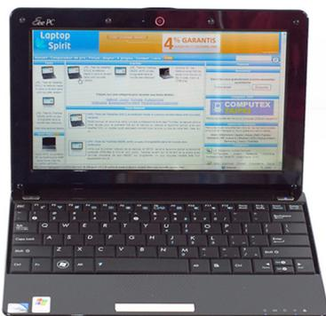
La differenza sostanziale è data dal case, più sottile nel 1008HA che, grazie a un'accurata ottimizzazione delle componenti interne non supera i **25.7mm di spessore**. Lo spessore minore determina anche un peso leggermente inferiore del 1008HA. Ecco dimensioni e peso in dettaglio:
