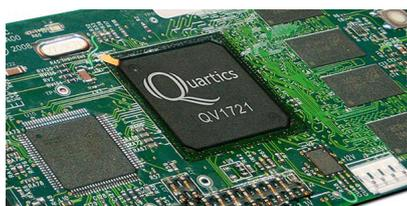
La peculiarità dell'AAO D256 consisterà nella presenza di un modulo PCI-Express mini-card in formato half-size, che ospita un **processore HD Quartics QV1721**. Scorrendo la [scheda tecnica sul sito del produttore](#), ci rendiamo conto che questa scheda offre alcune capacità di cui il suo concorrente più noto, Broadcom Crystal HD, è sprovvisto. Ci riferiamo in particolare alla capacità di convertire video in formato SD in HD e 2D in 3D!
